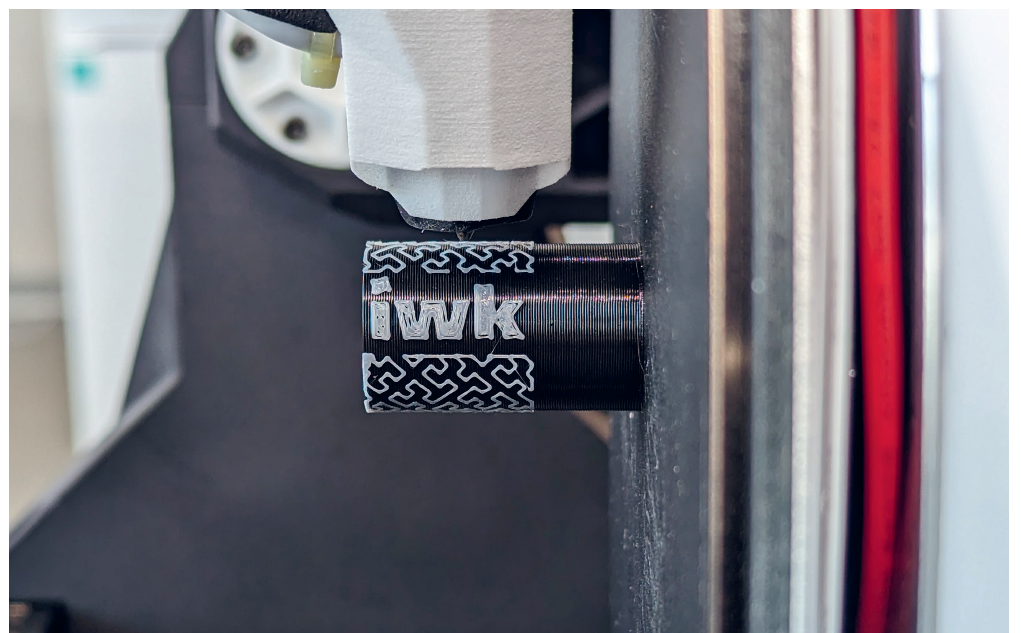
Einfacher Demodruck auf zylinderförmigem Substrat
